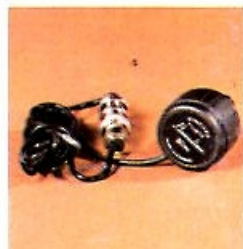
Syncro-pilote. Pour assurer la synchronisation du son entre la caméra et le magnétophone.
